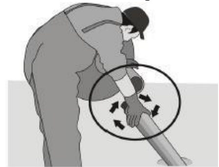
Рис. 1.3 Принципиальная схема опасности бурового инструмента.
